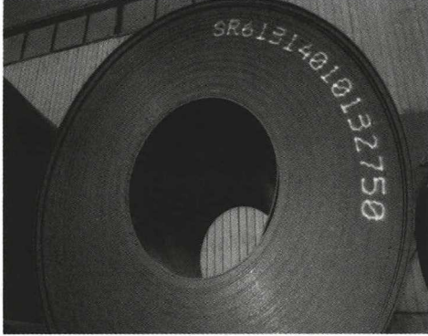
图 7 厚度 6.0 mm 的 S32750 钢热连轧卷板
